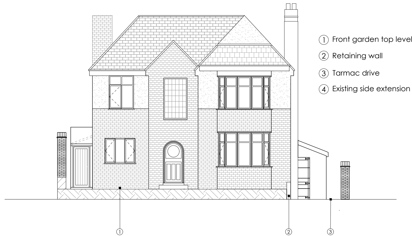
PP300 Existing Front Section A 1:100 @ A1
